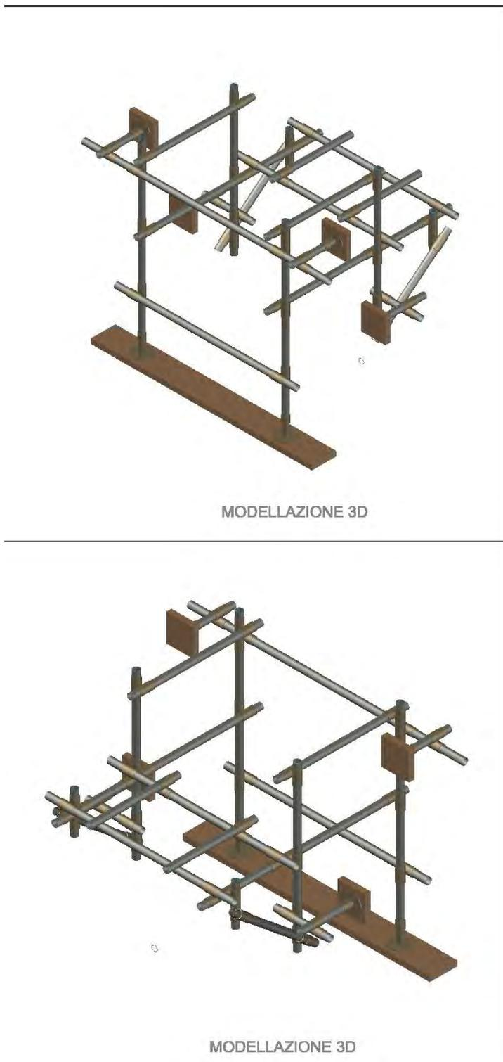
*Figura 12: Modellazione 3D del distanziatore in tubi e giunti.*
