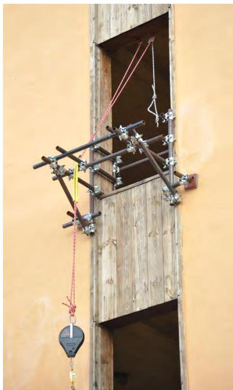
*Figura 8: Foto e schema tecnico dell'ancoraggio e del distanziatore che posiziona il dispositivo retrattile per l'esecuzione della manovra della scala a ganci.*
