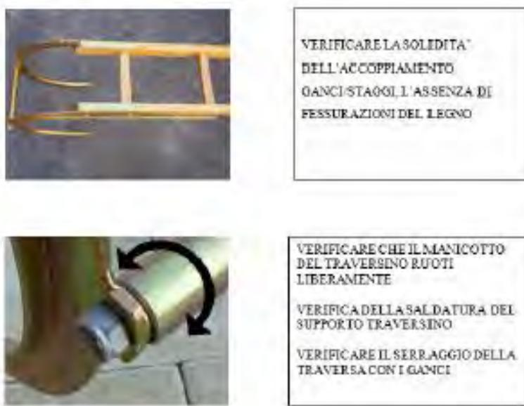
**Figura 24:** Controllo dei ganci della scala e del traversino in ferro posto tra i ganci stessi.
