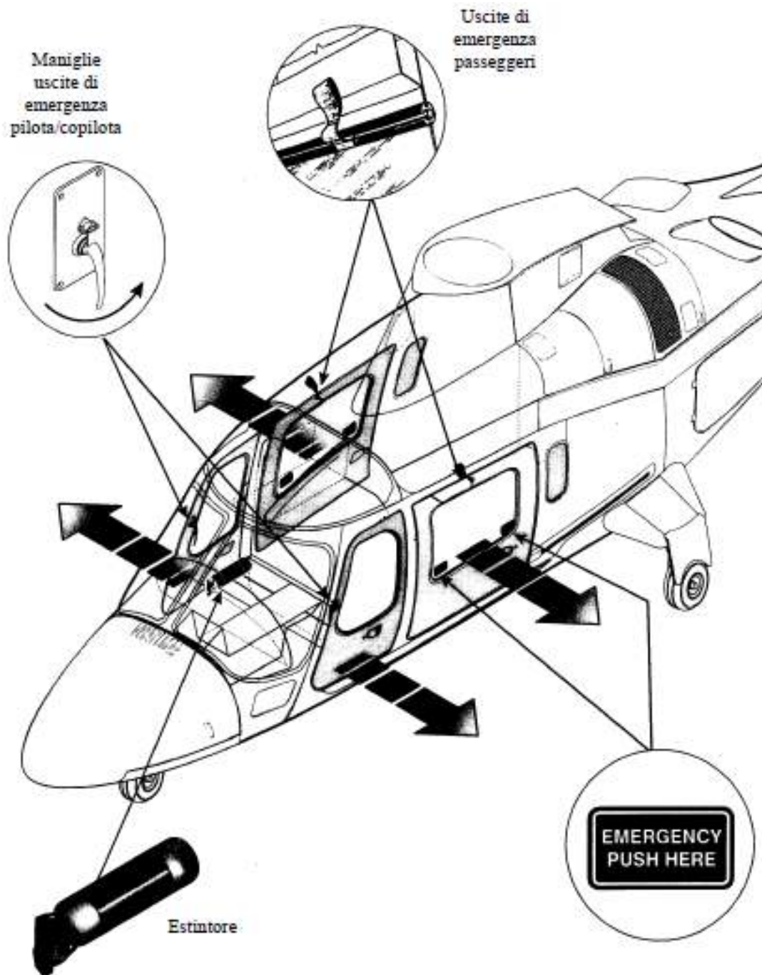
Localizzazione uscite di emergenza ed estintore
