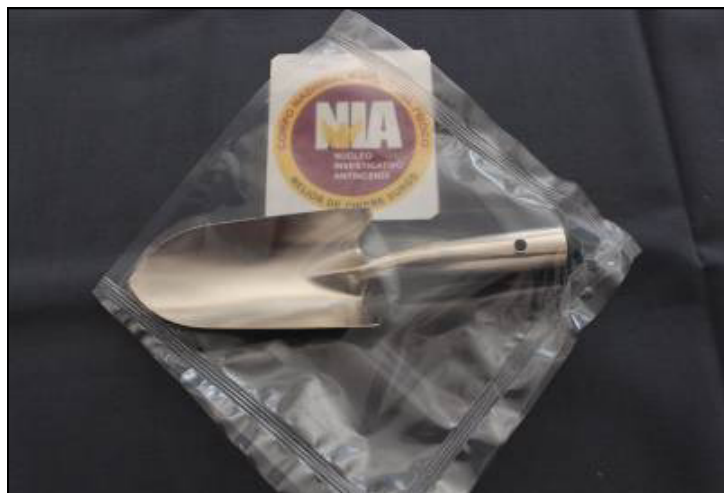
Foto n.4 Paletta di repertamento assoggettata all'applicazione della procedura di decontaminazione e confezionata in busta di plastica.
