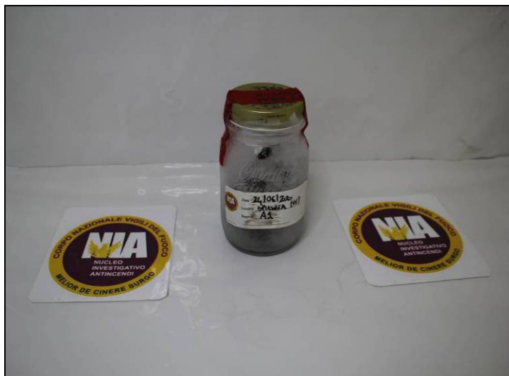
Foto n.5 Confezionamento ed etichettatura del reperto in barattolo di vetro con tappo metallico a vite sigillato con parafilm ed adesivo antistrappo tra barattolo e tappo.
