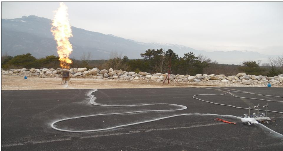
14) Arrestare la valvola fase liquida, aspettare lo spegnimento della fiamma, collegare la torcia fase gas, riaprire la valvola e riaccendere la torcia fino a pressione manometrica zero.
