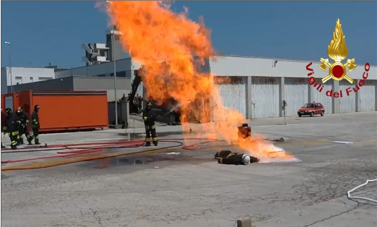
Il fenomeno è caratterizzato soprattutto dalle dimensioni della pozza e produce effetti dannosi soprattutto per irraggiamento.
