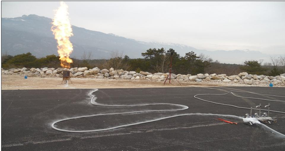
14) Arrestare la valvola fase liquida, aspettare lo spegnimento della fiamma, collegare la torcia fase gas, riaprire la valvola e riaccendere la torcia fino a pressione manometrica zero.
