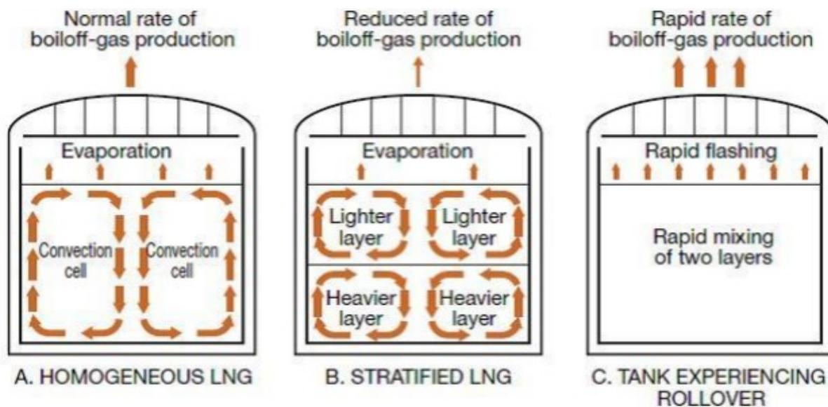
Questo è un fenomeno tipico di grandi recipienti nel caso di miscelazione di prodotti di origine diversa , prodotti a temperatura diversa oppure errori nelle procedure di messa in freddo dell'impianto prima del riempimento.
