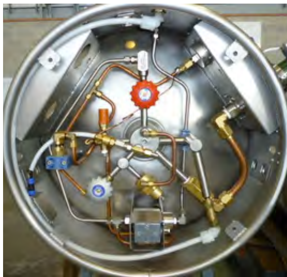
gruppo valvolare (mv) serbatoio LNG ece-ONU r110
