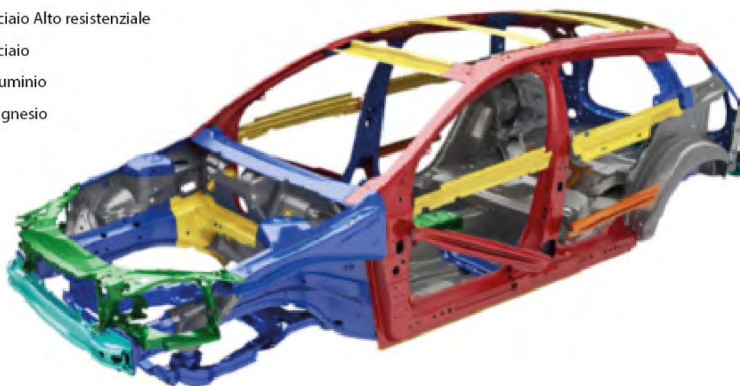
Esempio di distribuzione dei differenti acciai in una scocca
