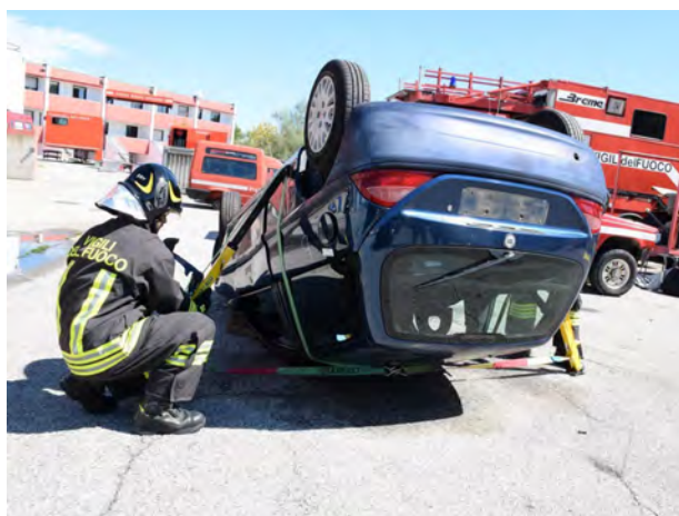
Nell'immagine: un veicolo capovolto sul tetto e stabilizzato
