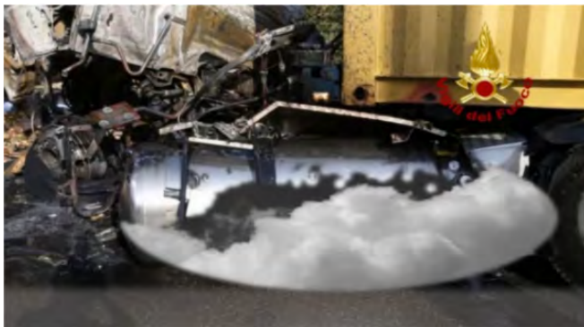
Formazione di ghiaccio sulla parte esterna del serbatoio indice di fuoriuscita del gas generata da possibile lesione.
