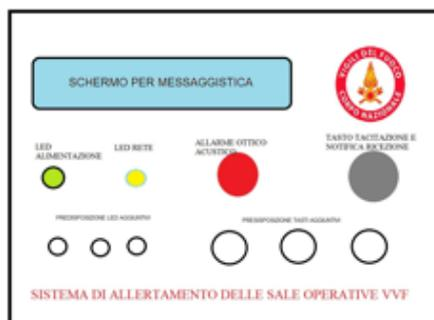
L'apparecchio è dotato in uscita esclusivamente di un cavo di alimentazione esterna a 220 V e di un cavo LAN da connettere ad un Personal Computer.
