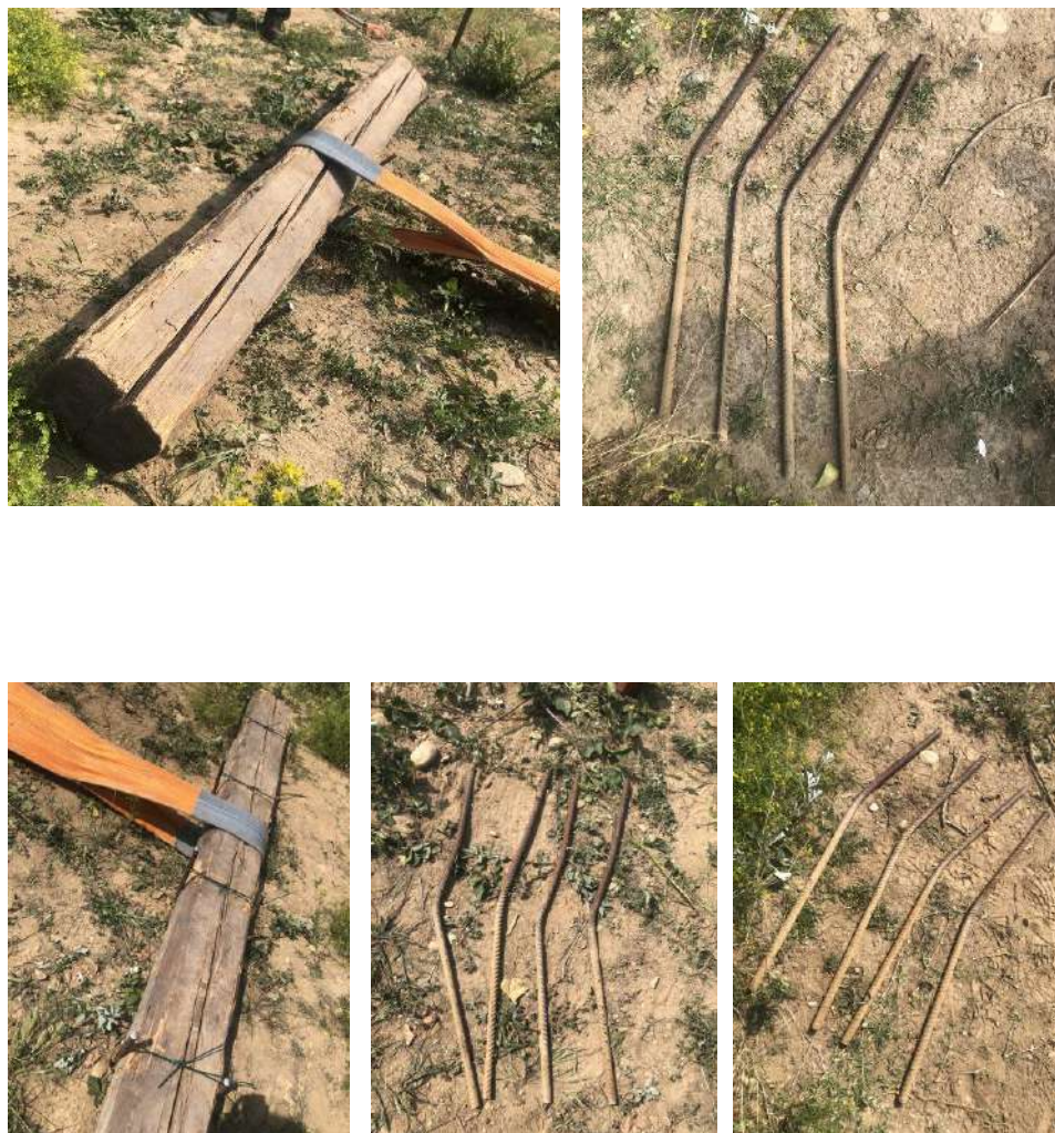
Figura 4.95 Foto delle prove su picchetti configurazione “S” (in alto) e “A” (in basso).
